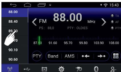
Нажмите кнопку на экране **←** и **→** для выбора предыдущей или следующей сохраненной станции. Для сохранения станции (частоты) в ячейку памяти устройства во время проигрывания станции нажмите кнопку на экране **+** в левой части экрана.
